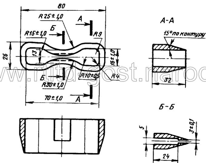
Схема штампа для нанесения меток
