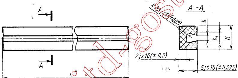
\* Размер  $L$  определяется технологическими возможностями изготовителя.
